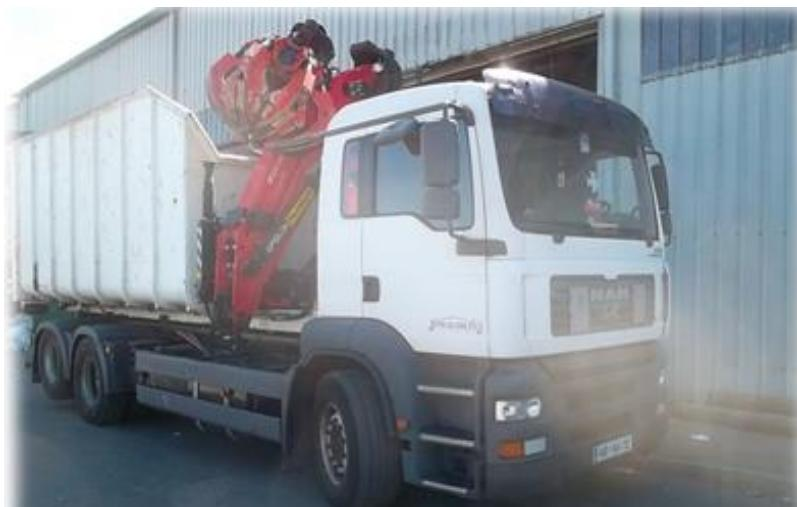
Slika 13: Vozilo za zbiranje odpadkov s kotalnim prekucnikom
