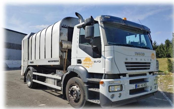
Slika 11: Vozilo za zbiranje odpadnega stekla
