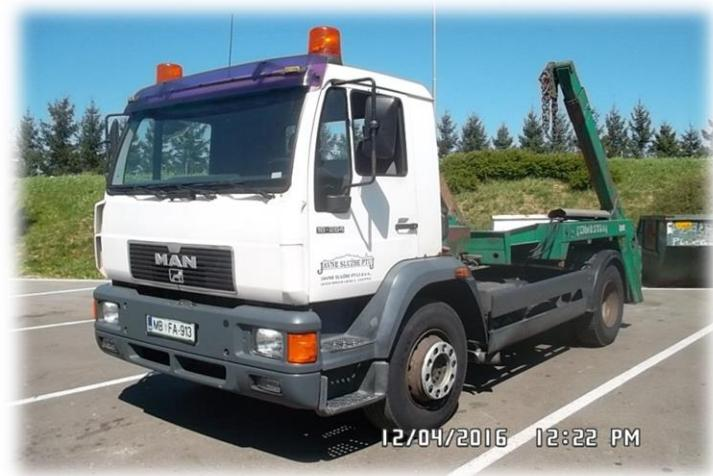
Slika 7: Vozilo za odvoz kontejnerjev manjših volumnov
