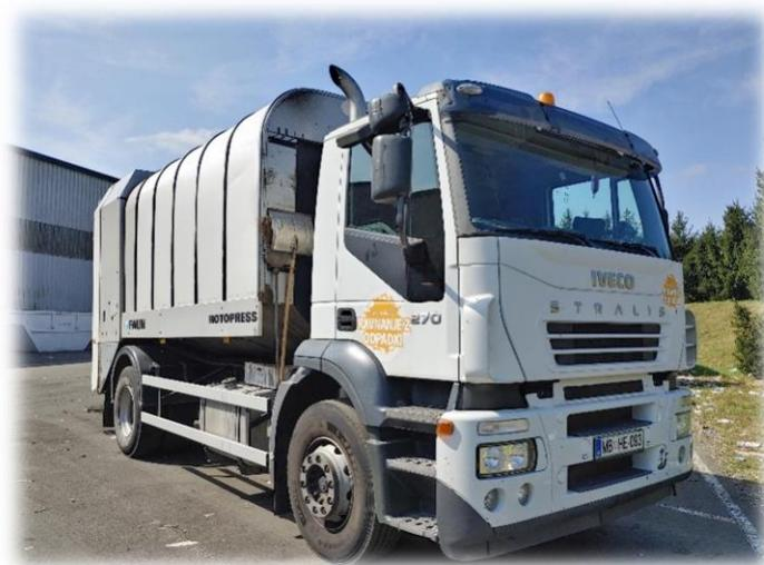
Slika 14: Vozilo za zbiranje odpadnega stekla
