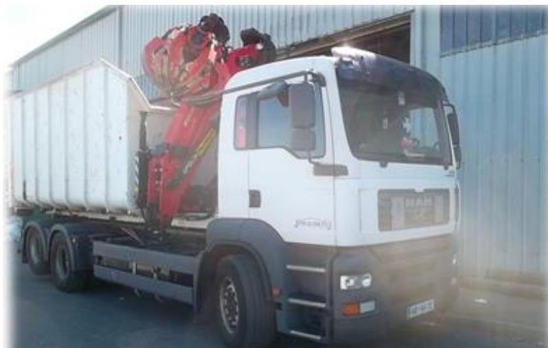
Slika 16: Vozilo za zbiranje odpadkov s kotalnim prekucnikom
